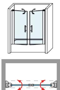
Una línea de mampara de estilo contemporáneo, que destaca por su estética e indudable funcionalidad, con apertura interior y exterior. El eje de giro incorpora sistema "Bottom Up", para que la apertura y cierre de la puerta se realice con el mínimo roce de la goma de estanqueidad con el plato.
