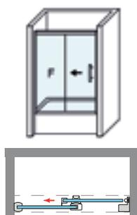
Un diseño innovador, basado en la estética minimalista que brinda el perfil inferior de reducidas dimensiones (7 mm.) y la elegancia, que otorga las puertas exentas de goma magnética. La guía base desmontable y ajustable al espesor del vidrio incorpora dispositivo de liberación de puertas para su fácil limpieza y conservación.
